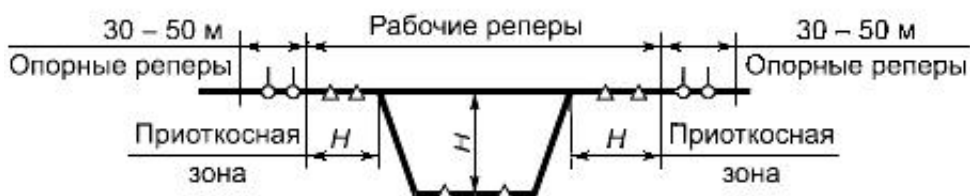
б) Разрез сооружения
